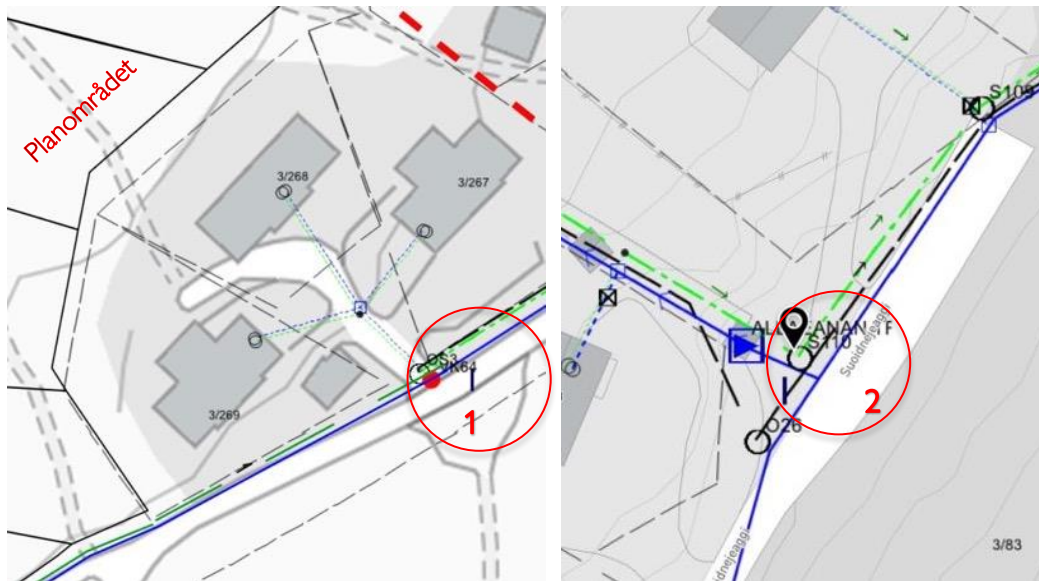
Figur 31 // Kartutsnitt fra VA-rapport. T.v. vises VK 64 og OS3 for planlagte hoved påkobling, og t.h. vises ønsket med ekstra påkobling med rundkjøring i S110 og O27.
