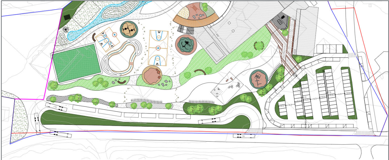
Figur 17 Alternativ 2 med «drop off» og P-plass i nord og bussholdeplass langs Bredbuktnesveien.
