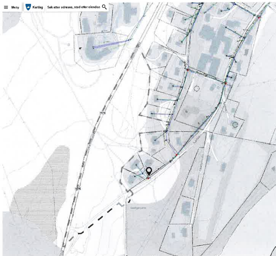
Figur 17 // Kommune-kart av eksisterende VA-anlegg Røde prikker viser brannkummer. Planområde i grå stipling
