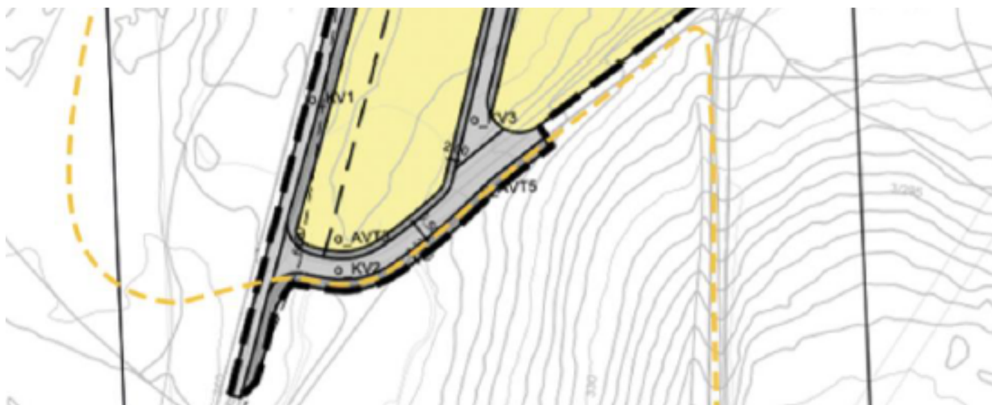
Figur 5 Under vises trasée på plankartet. Sidearealett til veien (AVT) er regulert med 3 m bredde.
