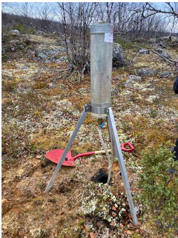
Bilde 2: Infiltrasjonstest ble utført ved S1
