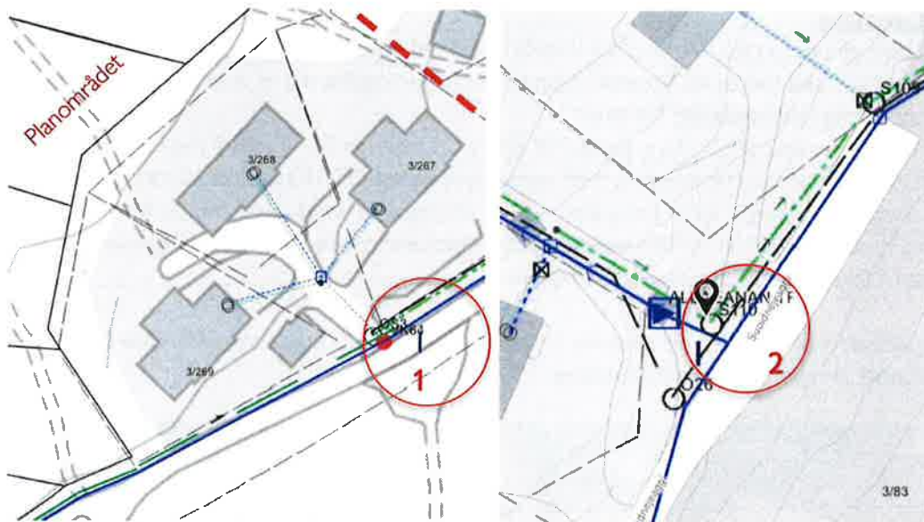
Figur 31 // Kartutsnitt fra VA-rapport. T.v. vises VK 64 og OS3 for planlagte hoved påkobling, og t.h. vises ønsket med ekstra påkobling med rundkjøring i S110 og O27.
