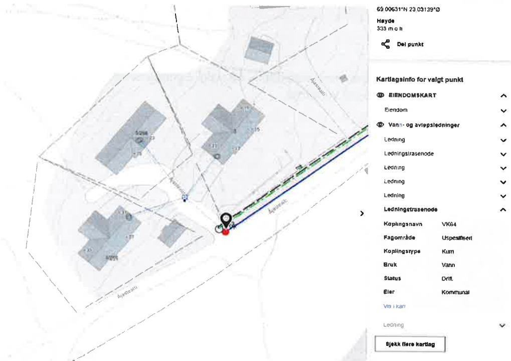
Figur 16 Kart brannvannsdækning. Viser 2 tilgjengelige brannkummer langs Ajastealli med kapasitet 20-50l/s. Tilsendt av Kautokeino Kommune avdeling VA.
