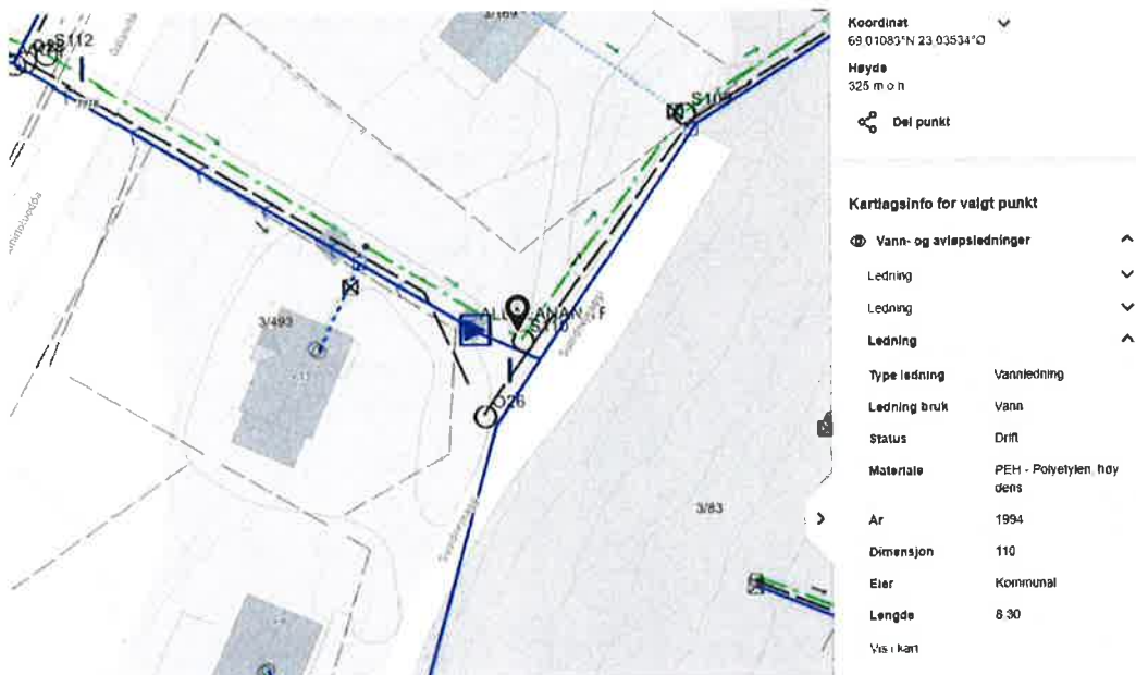
Figur 11 Ny VA-anlegg påkoblingspunkt – Ønske av Kautokeino Kommune for rundkjøring av vann.
