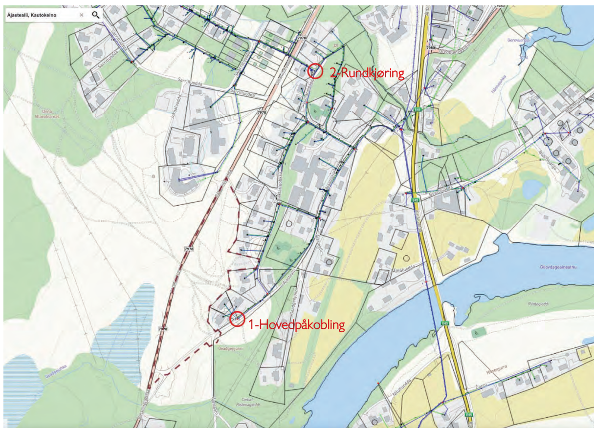
Figur 30 // Oversiktskart fra kommunens kartportal. Nederste rød sirkel viser planlagt koblingspunkt for VA til planområdet. Sirkelen lenger opp viser ekstra påkoblingspunkt der kommunen ønsker rundkjøring.
